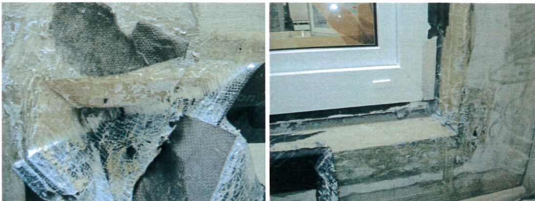
Abb.5: ausreichende Klebeeigenschaft der Diffusion Top Fensteranschlussfolie nach Einzelprüfungen
