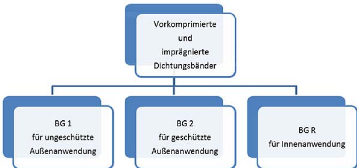
Abbildung 8: Vorkomprimierte und imprägnierte Dichtungsbänder aus Schaumkunststoff
