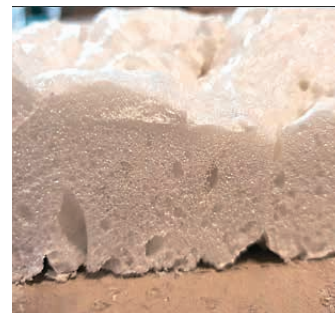
RALMO ® -DÄMM feinzell Querschnitt nach 4 Stunden bei -15 °C Lagerung. Struktur sehr fein und nicht spröde.
